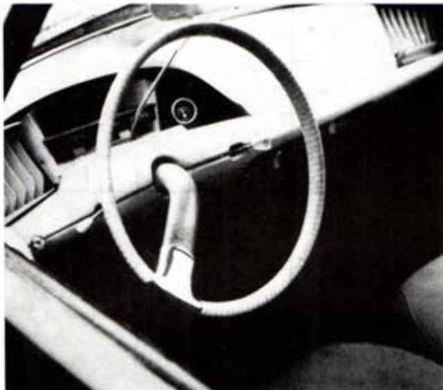
Instrumentpanelen på de tidiga DS19 (tom 1961) skiljer sig markant från den på senare årsmodeller. Bl.a. finns en mekanisk klocka på framsidan av askkoppen.
