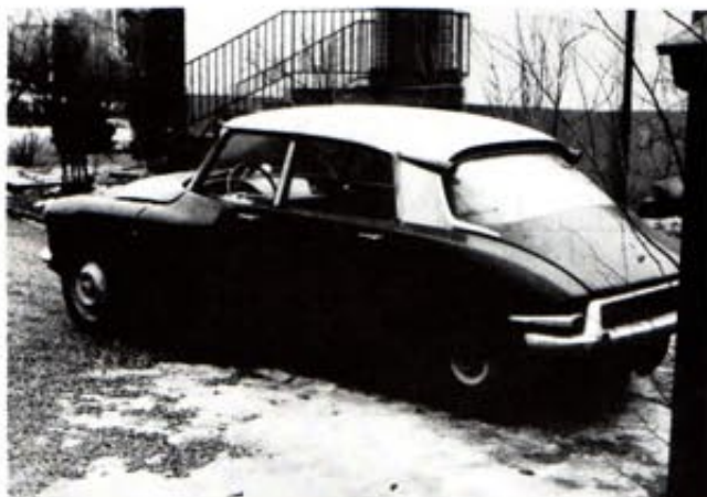
Typiskt för DS19 1956-1959 är de korta bakskärmarna med den gjutna lättmetallisten för reflektorn.
