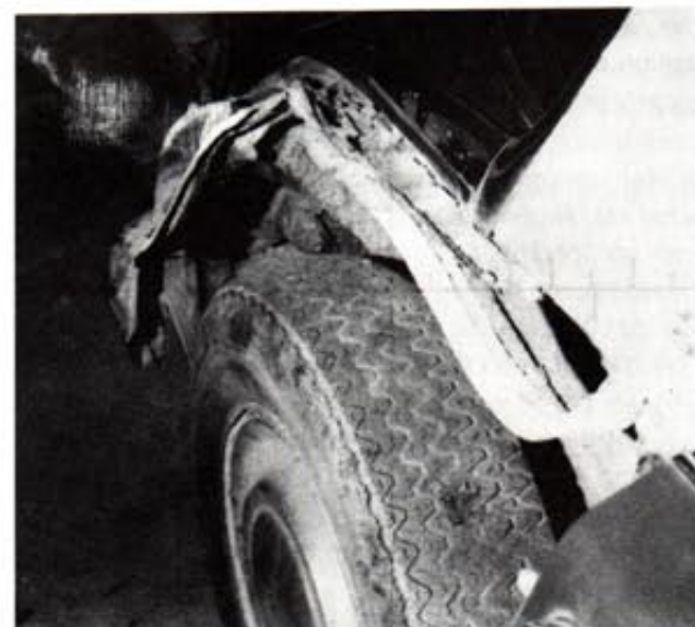
Tyvärr är det en ganska vanlig syn när bakskärmn monterar av: Rost i hjulhus och skärminnfästningar. Så här såg det ut hos ovan nämnda DS21.
